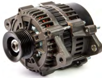
18-6298 ALTERNADOR Reemplaza: 863077T • SAE J1171 7SI/70 amp, montaje bisagra, Polea de serpiente 1.97" Diámetro
