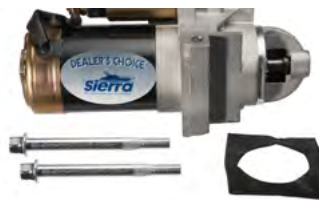
18-5913 MOTOR DE ARRANQUE Reemplaza: 3856004, 3860764, 3587625, 3853982, 3854751, 3885317 (sentido reloj) 2 tornillos 12V - 11 dientes tornillos desplazados Para: Último modelo GM 14" volante Reemplaza solenoide: 18-6287 SAEJ1171 1.7 KW
