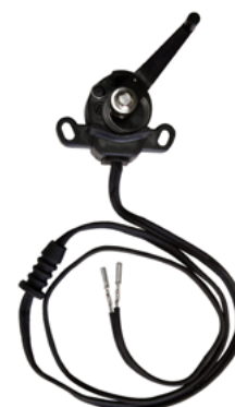
18-7634 TRANSMISOR TRIM Reemplaza: 984748 Para: OMC Cobra
