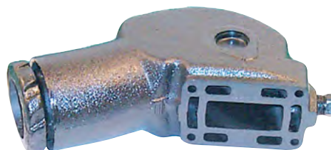
18-1936 HGE 18-1936S CODO ESCAPE Reemplaza: 857037 Para: 4.3L Para: AQ175, AQ430, AQ431A, AQ431B, AQ432, AQ434 Usar con: Junta codo escape: 18-2971-1 Kit montaje: 18-19360
