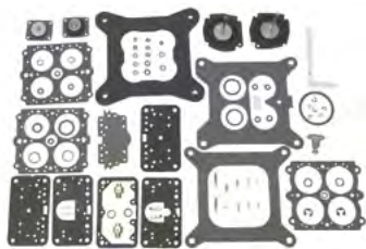
18-7017 KIT CARBURADOR Reemplaza: 985052 235 (5.8L Ford) 1989 7.5L/460 C.I. 1987-89 (Contiene agujas y asientos ajustables)
