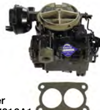
18-7608-1 CARBURADOR 2 cuerpos - Rochester Reemplaza: 1347-818620, 1347-818620 1, 1347-818620R02 (Remanufacturado) Use kit carb 18-7070 & junta 18-0356
