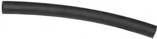
18-3602 MANGUERA ENTRADA AGUA Reemplaza: 32-4172533, 32-8M0062309 13 \frac{7}{8} " Largo - \frac{3}{4} " D.I. Para: MR, Alpha I, Gen II
