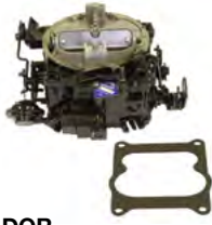
18-7639 CARBURADOR Reemplaza: 3310-864943A01, 86125A1 Mercarb-5.7L 2V 1998 y nuevos 5.7L (OL010337-OW300754) & 5.7L MIE (OL002003-OW090899) (Remanufacturado) Use kit carb 18-7098-1 & junta 18-0994
