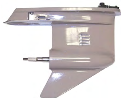
18-4801 PARTE INFERIOR COLA Reemplaza: 50000356. Para: 85-140HP.
