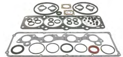
18-3870 KIT JUNTAS CULATA Reemplaza: 876303 Para: B25, 251A, AQ171A, AQ171C
