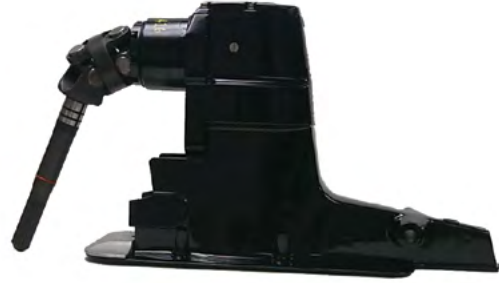
18-2418 PARTE SUPERIOR Reemplaza: 1547-815930A4, 1547-861063A8, 1547-815930A14 Para: Gen II (1991 & SUP) para engranajes ratios 1.81:1, 1.84:1. Usado con: 18-2411 Alojamiento
