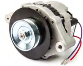
18-5966 ALTERNADOR Polea de ranura única • 55 Amp Reemplaza: 817119A4, 12449A1, 98555A1, 92497, 817119A1, 12449A1, 12449 • SAE J1171
