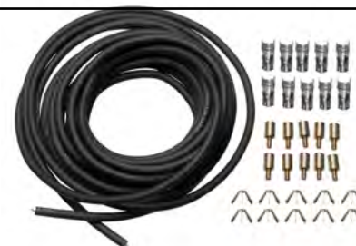
18-5225 KIT CABLE BUJÍAS Reemplaza: Mercury 84-99215A26, 84-813706A26 Kit Incluye 25 pies de cable de encendido 7 MM Hypalon de alma de cobre y un amplio surtido de 3 tipos de terminales.
