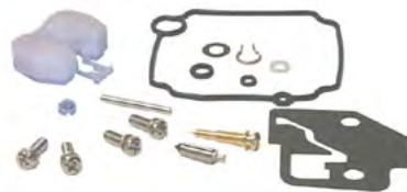
18-7738 KIT CARBURADOR Reemplaza: 802706A1 Para: 9.9 4 Tiempos (323cc) (1999 & sup) y 15.4 tiempos (1998 & sup)
