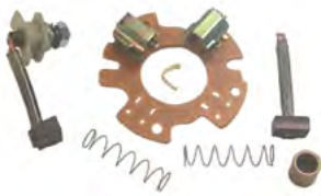
18-6250 ARRANQUE FUERABORDA KIT REPARACIÓN Prestolite 2 Escobillas
