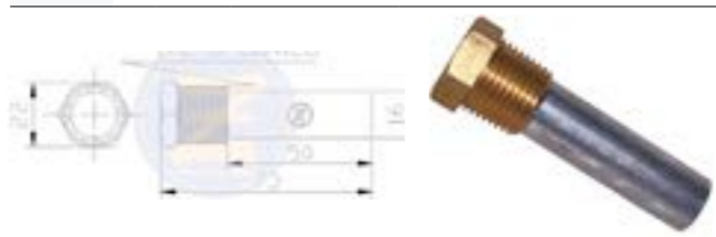
11957418790 Zn 0,145 Yanmar. Ánodo cabeza de latón 1/2 Gas Cónica (BSPT) para refrigerador motores Yanmar 6LP/6LY/4LH. #OEM 119574-18790
