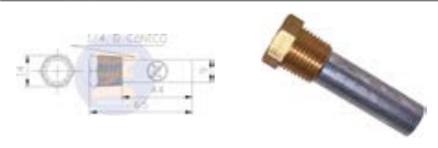
025477 Zn 0,04 Westerbeke. Ánodo tuerca de latón rosca 1/4 G Cónico para Westerbeke 3,3; 4,0; 22WTA; 23,5 EDE Series. #OEM 11885
