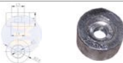
025392 Zn 0,033 Honda. Ánodo disco para Honda BF8-40 HP, BF75-130 HP. #OEM 12155-ZV4-A00 #OEM 12155-ZW5-000
